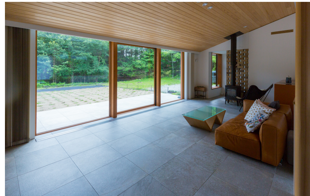
薪ストーブ背面壁は、耐熱煉瓦のため蓄熱壁ともなる。隙間を設けることで空間を緩やかに仕切る。
